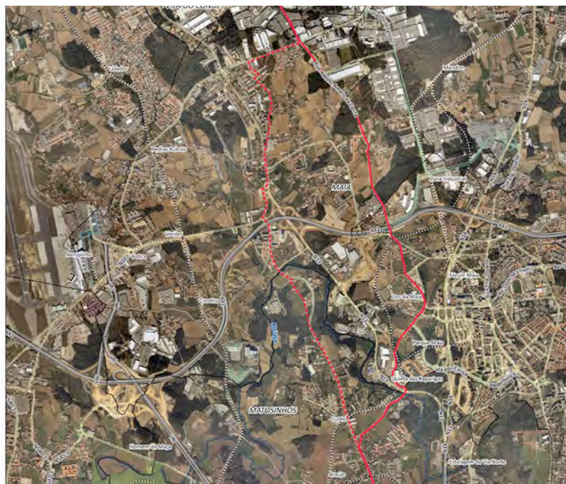
Ilustração 3: Detalhe da variante de Ponte Moreira (Moreira da Maia, Maia) sobre ortofotografia à escala 1:25.000. O traçado original aparece em linha contínua, e a variante, em linha descontínua. Fonte: Elaboração própria
