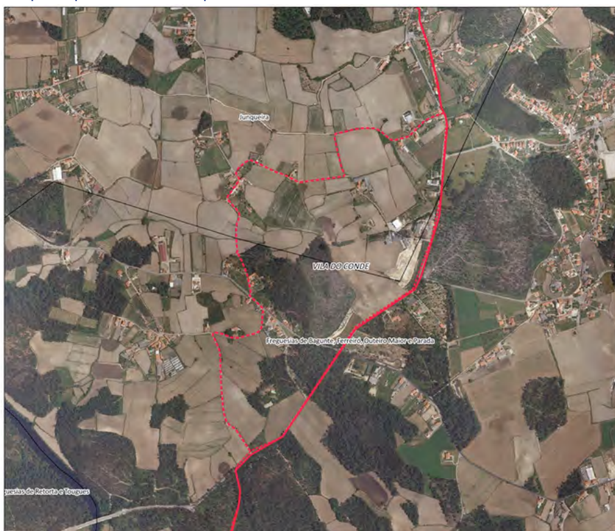
Ilustração 5: Detalhe da variante de Santagões (Bagunte, Vila do Conde) sobre ortofotografia à escala 1:10.000. O traçado original aparece em linha contínua, e a variante, em linha descontinua. Fonte: Elaboração própria
