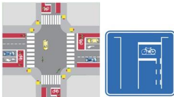
Figura 55 – Intersecção com semáforos com plataforma avançada de espera para bicicletas. Fonte: Diputacion Foral de Bizkaia
