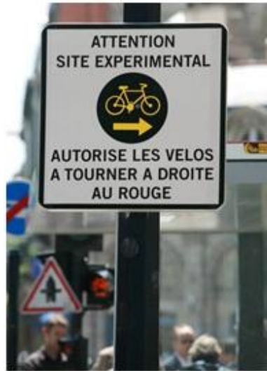
Figura 56 - Sinalização vertical de viragem à direita para ciclistas na cidade de Bordéus. Fonte: http://www.bordeaux.fr
