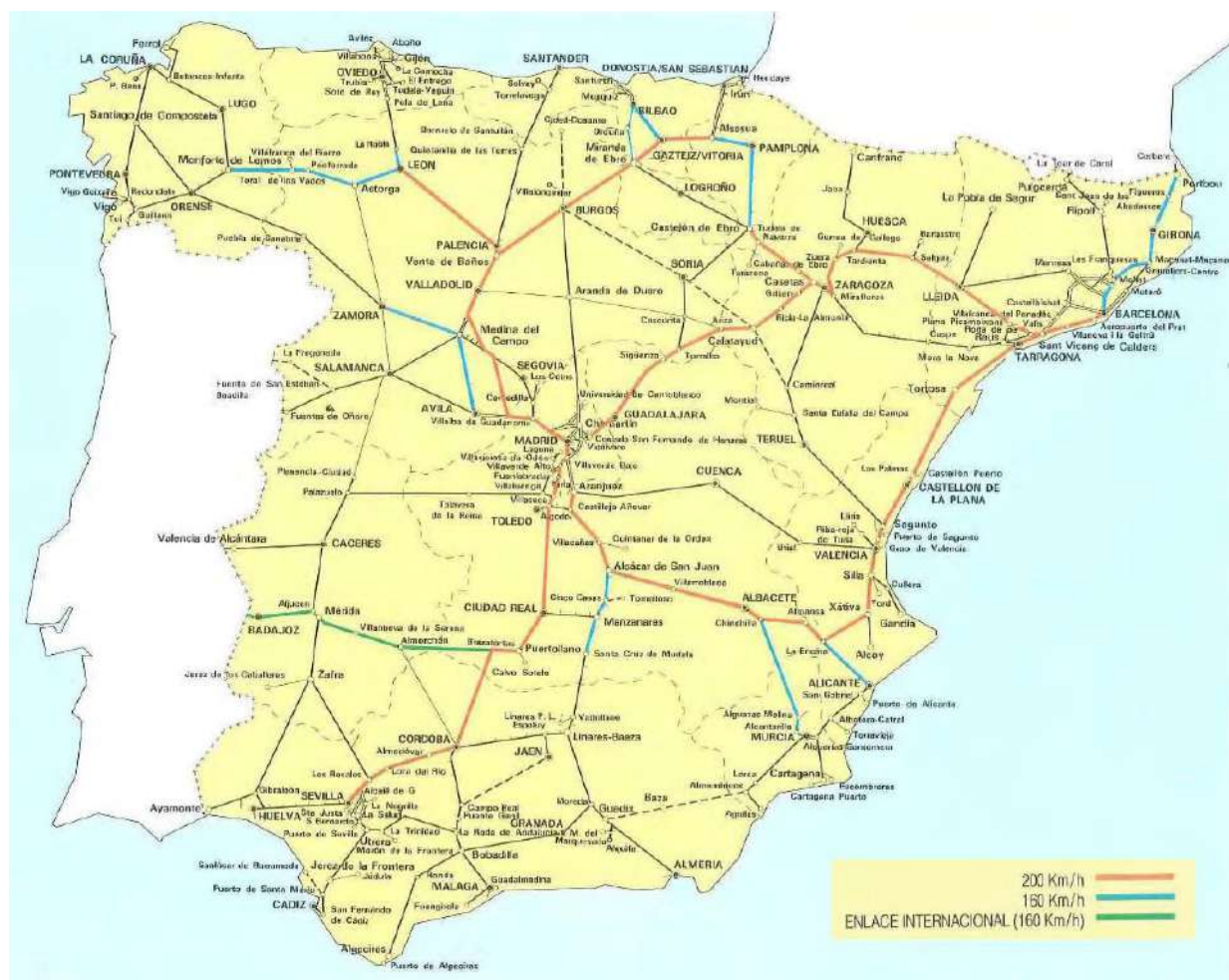
Figura 18. Velocidades tipo objetivo del Plan de Transporte Ferroviario. (Ministerio de Transportes, Turismo y Comunicaciones 1987)
