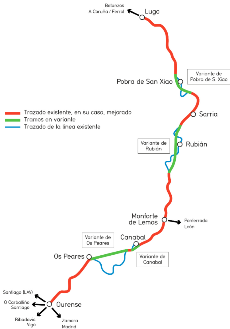
Figura 5. Esquema de la modernización de la línea Lugo - Ourense planteada en el Estudio Informativo licitado por el Ministerio de Fomento en 2000.
